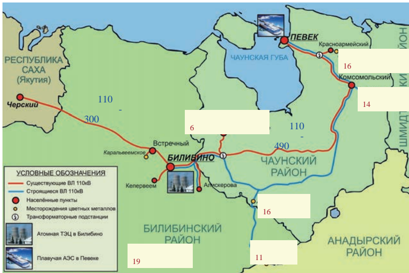
Рис. 7. Схема электроснабжения Чаун-Билибинского энергоузла
